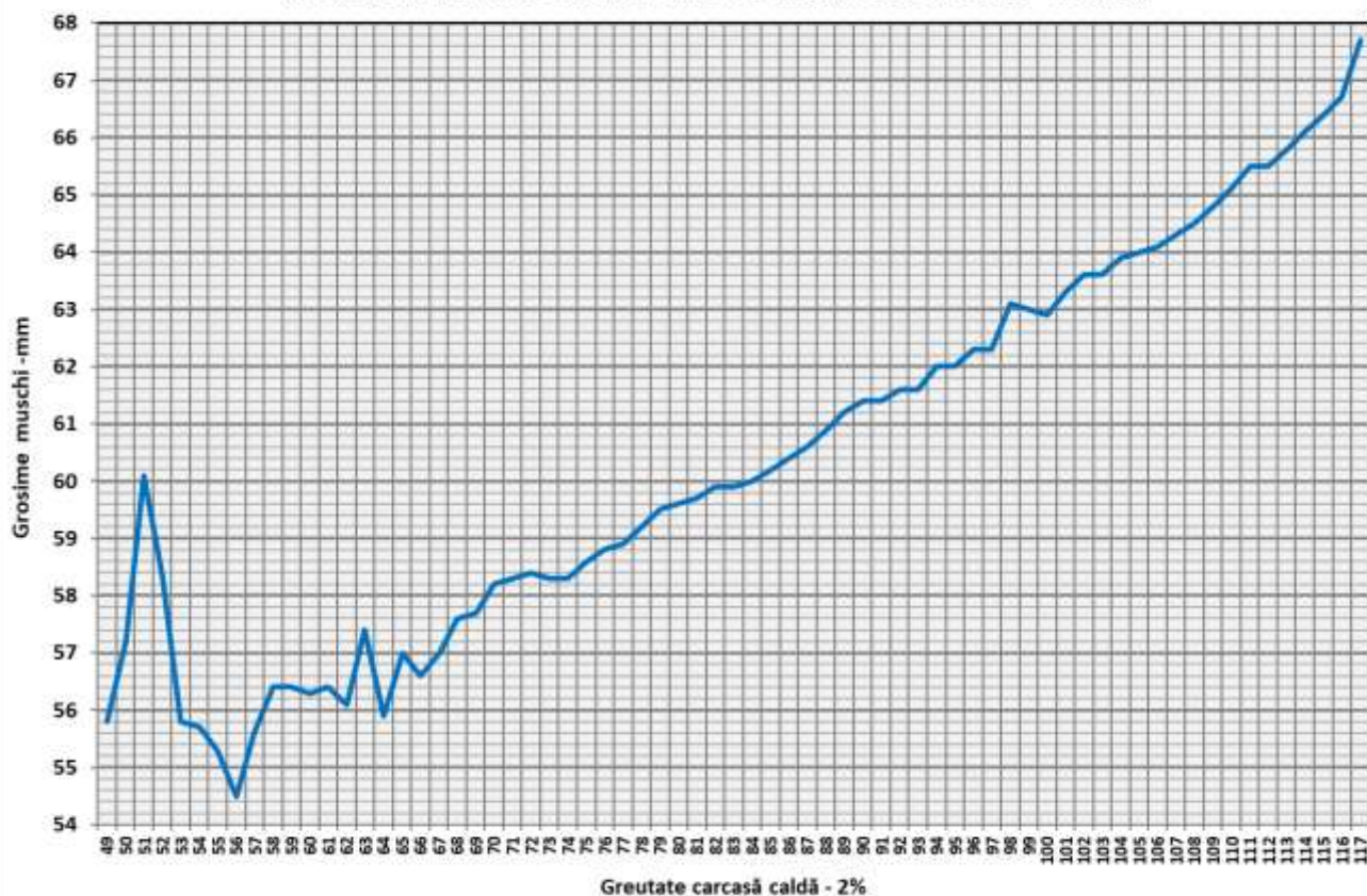
Grosimea muschiului cu echipamentul cu sondă optică OptiGrade-Pro în România în funcție de greutatea carcasei calde - 2% în trimestrul I 2022 (N = 596,233)
